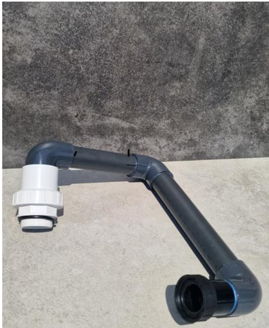
Obrázok 7 - prepojovacie potrubie DN50. Prepojovacie potrubie medzi čerpadlom a filtračnou nádobou so šróbeniami DN50 na oboch koncoch.
