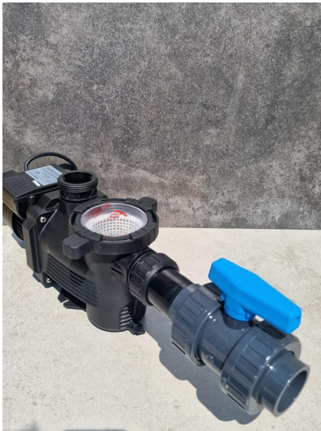
Obrázok 3 - čerpadlo s predfiltrom. Filtračné čerpadlo s predfiltrom a guľovým ventilom. Do predfiltra sa vkladá menšie množstvo mikrofiltračného média.
